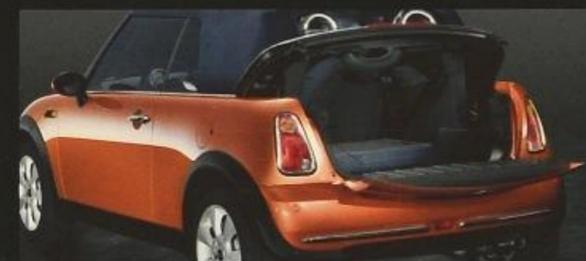
Schwenken Sie die Heckklappe nach unten und heben das hintere Verdeckteil bei geschlossenem Verdeck nach oben (Easy Load). Mit den einzeln umlegbaren Rücksitzen entsteht so ein Ladevolumen von bis zu 605 l.
