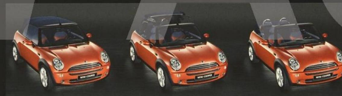
Das Verdeck im MINI Cabrio lässt sich auf Knopfdruck nicht nur vollständig öffnen oder schließen (in nur 15 Sekunden), sondern auch als Schiebedach nutzen – bis 40 Zentimeter weit, und auch während der Fahrt bis 120 km/h.
