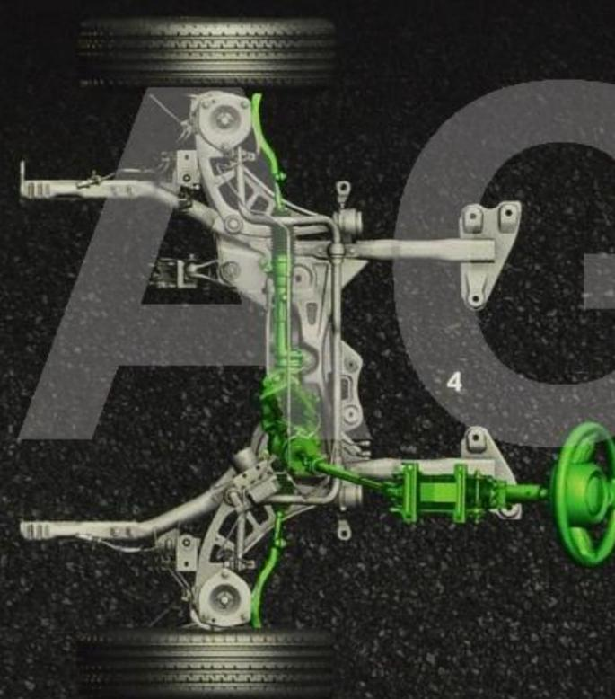
**1 EINGELENK-FEDERBEIN-VORDERACHSE.** Zwei gleich lange Antriebswellen an der Vorderradaufhängung vermindern den Einfluss des Antriebs auf die Lenkung. Und optimieren damit das Fahrverhalten beim Kurvenfahren, Beschleunigen und Bremsen.
