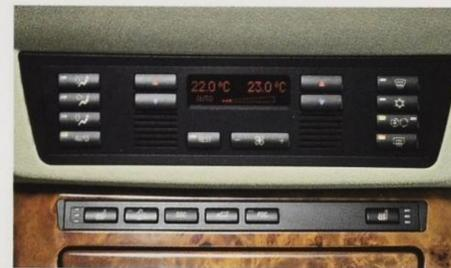
□ **Klimaautomatik**, inkl. AUC, sorgt schnellstmöglich für Ihr Wunschklima im Innenraum und hält eine vorgewählte Temperatur konstant; mit der integrierten Automatischen Umluft Control (AUC) gelangen Schadstoffe aus der Luft ab einer bestimmten Konzentration nicht mehr ins Fahrzeuginnere (Umluftbetrieb) (Serie 4.4i und 4.6is).
