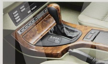
□ **5-Gang-EH-Automatic mit Steptronic**, Adaptiver Getriebesteuerung (AGS), Shift-/Interlock; mit der Steptronic lässt sich das Automatikgetriebe wahlweise auch wie ein Schaltgetriebe nutzen (ohne zu kuppeln); (Serie 4.4i, 4.6is und 3.0d).
