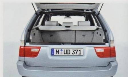
■ **Heckklappe** ist horizontal zweigeteilt; der untere Teil bildet in geöffnetem Zustand eine mit 200 kg belastbare Plattform (z. B. zum Abstellen schwerer Gegenstände). Der obere Teil lässt sich separat öffnen (z. B. zum schnellen Herausnehmen von Kleinigkeiten).
