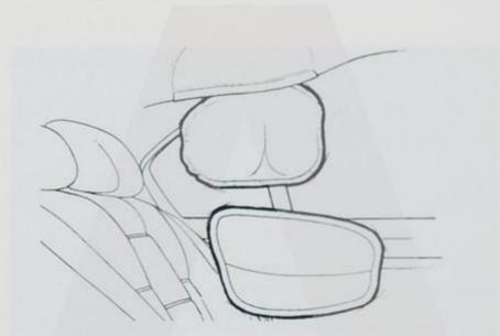
□ **Airbag-System im Fond:** Bei einer seitlichen Kollision werden Kopf und Oberkörper durch den Kopf-Airbag geschützt; der Seiten-Airbag verringert das Verletzungsrisiko im Becken- und Brustbereich erheblich. (Serie 4.6is.)
