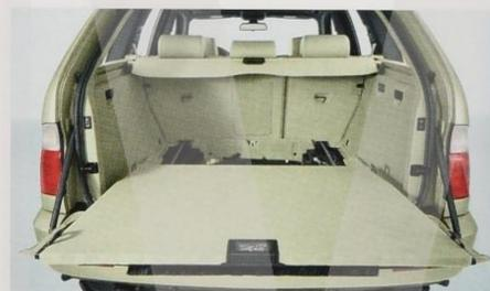
□ **Ladeboden, ausziehbar**, erleichtert das Verstauen schwerer Gegenstände erheblich; die maximale Tragkraft beträgt 150 kg.
