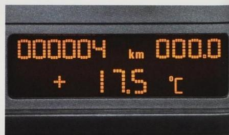
■ **Bordcomputer** inkl. Check-Control informiert unter anderem über Durchschnittsgeschwindigkeit, Durchschnittsverbrauch, Reichweite und Außentemperatur.
