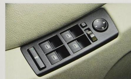
■ **Fensterheber** vorn und hinten elektrisch, Tasten untergebracht in den Armlehnen, mit Mautschaltung „Auf-Zu“ vorn und hinten, Einklemmschutz und Komfortschliebung rundum.
