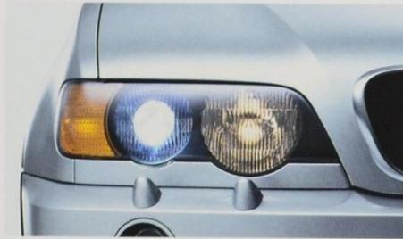
□ **Xenon-Licht** ermöglicht eine deutlich bessere Fahrbahnausleuchtung bei schlechter Witterung oder Sicht – die Leuchtkraft ist mehr als doppelt so hoch wie bei herkömmlichen Halogenlampen (nur in Verbindung mit Scheinwerfer-Reinigungsanlage erhältlich). (Serie 4.6is.)
