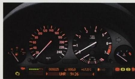
■ **Instrumententafel** (hier abgebildet 4.4i) mit Analoginstrumenten und roter Durchlichtbeleuchtung, Drehzahlmesser mit Energie-Control, Tankuhr, Kühlmittelthermometer, LC-Display für Kilometer- und Tageskilometerzähler, Digitaluhr und Check-Control.
