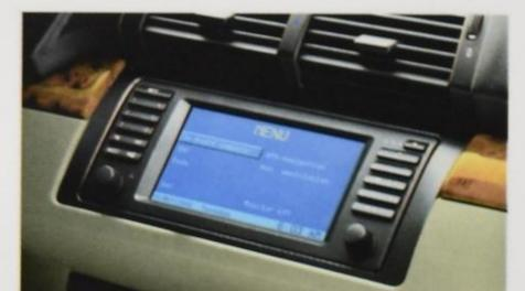
□ **Navigationssystem mit 16:9-Bordmonitor**, TV und Radio Professional mit Cassetten-Laufwerk. Notwendige Fahrhinweise gibt der Sprachcomputer, zusätzliche Infos können per Richtungspfeil oder Übersichtskarte abgefragt werden, ebenso Infos, z. B. über Hotels. Mit der Splitscreen-Funktion des Monitors lassen sich z. B. Radio und Navigationssystem parallel anzeigen.
