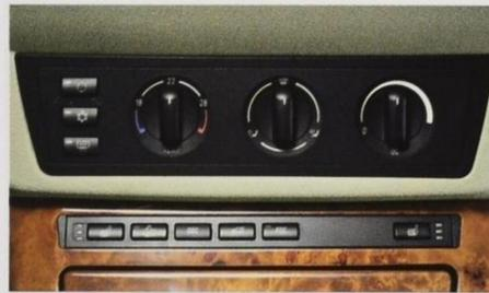
■ **Klimaanlage**, inkl. Mikrofilter, für komfortables Innenraumklima zu jeder Jahreszeit; Luftmengenregelung und Luftverteilung manuell einstellbar (Serie 3.0i und 3.0d).
