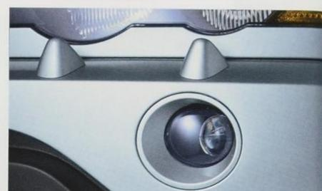
■ **Nebelscheinwerfer** in Freiformtechnik, in die Frontschürze integriert, sorgen für mehr Sicherheit bei schlechten Sichtverhältnissen.
