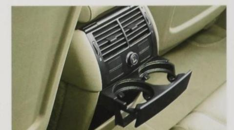
□ **Cupholder** (zwei), in die Fondmittelkonsole integriert, herausziehbar; (Serie 4.4i und 4.6is) darunter befindet sich ein zusätzliches Ablagefach. Enthalten in den Sonderausstattungen Edelhölzausführung oder Sportpaket.
