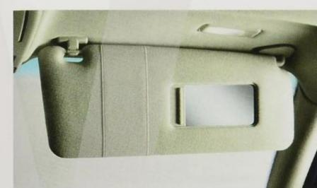
■ **Make-up-Spiegel**, beleuchtet, mit Abdeckschieber für Fahrer und Beifahrer.
