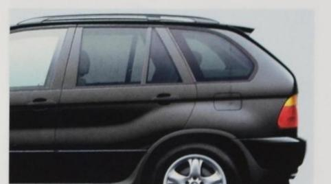
□ **Sonnenschutzverglasung** für hintere Seitenscheiben (ab B-Säule) und Heckklappe; die getönten Scheiben verringern die Blendwirkung und sorgen bei hohen Außentemperaturen für ein angenehmes Innenraumklima.
