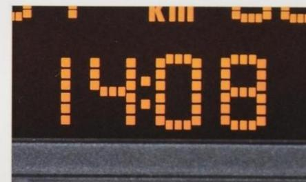
■ **Digitaluhr**, gut ablesbar und blendfrei in der Instrumententafel angeordnet, ermöglicht jederzeit ein einwandfreies Ablesen der Uhrzeit.
