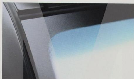
□ **Klimakomfort-Frontscheibe** reduziert die unangenehme Aufheizung des Innenraums mittels einer Infrarotlicht reflektierenden Schicht; der Grünkeil am oberen Scheibenrand verhindert eine direkte Blendung durch die Sonne.
