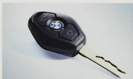
■ **Zentralverriegelung** mit elektronischer Wegfahrsperre, Funkfernbedienung und Center-Lock-Schalter; über das Öffnen der Zentralverriegelung lassen sich auch am Fahrzeug programmierte Einstellungen (Car Memory) oder auf bis zu vier Fahrer und Schlüssel bezogene persönliche Einstellungen (Key Memory) aktivieren.
