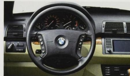
□ **Multifunktion für Lenkrad**, für Geschwindigkeitsregelung und Fernbedienung für Radio bzw. Telefon (Serie 4.4i).
