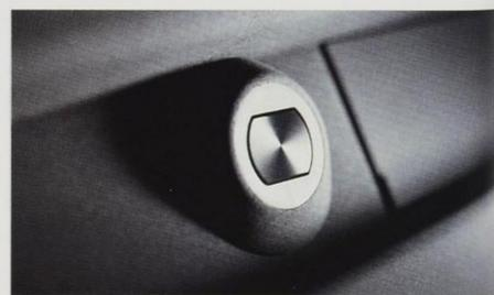
□ **Park Distance Control (PDC)** für Front und Heckbereich; erleichtert das Einparken und Rangieren auf engstem Raum, die Entfernung zwischen Ihrem Fahrzeug und einem Hindernis wird akustisch gemeldet.
