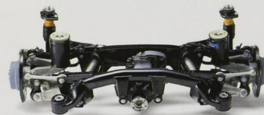
Was Sie hier sehen, ist der Schlüssel zum Fahrspaß: die Integral-Hinterachse. Das Achssystem sorgt mit gleichmäßiger Gewichtsverteilung auf Vorder- und Hinterachse für Agilität und gutes Handling, charakteristische Eigenschaften eines jeden BMW. Die praktische Nebenwirkung: Der kleine Wendekreis macht das Rangieren leichter und zahlt sich dann spätestens im Parkhaus aus.
