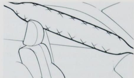
■ **ITS-Kopf-Airbag** für Fahrer und Beifahrer gewährleistet wirkungsvollen Schutz für Kopf und Oberkörper bei einer seitlichen Kollision.
