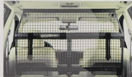
■ **Gepäckraumtrennnetz** verhindert, dass Gegenstände nach vorn in den Fahrgastraum fallen; lässt sich sowohl bei hochgestellter als auch bei umgeklappter Fondsitzlehne verwenden.
