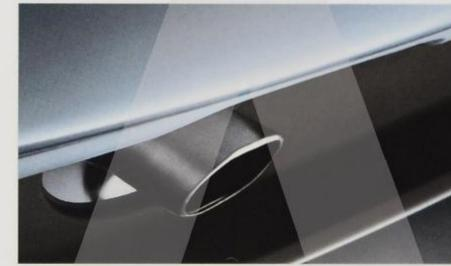
■ **Auspuffendrohre:** Der X5 3.0i ist serienmäßig mit zwei Einzelrohren ausgestattet. Die Auspuffanlage ist in hochwertigem Edelstahl ausgeführt, die Enden sind optisch attraktiv leicht nach unten abgeschrägt. (Beim X5 3.0d sind die Endrohre von hinten nicht sichtbar.)
