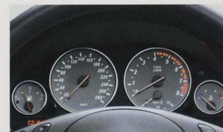
**Instrumententafel:** Sämtliche Analoginstrumente sind mit einem feinen Chromring umrandet, der Drehzahlmesser ist mit einem variablen Vorwarnfeld ausgestattet.
