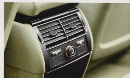
□ **Fondklimatisierung** ermöglicht zu jeder Jahreszeit ein komfortables Innenraumklima für die Fondpassagiere; über ein separat einstellbares Gebläse können Luftmenge und Luftverteilung im Fond individuell eingestellt werden.
