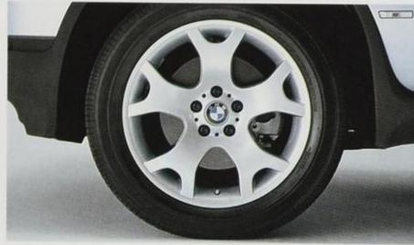
**BMW Leichtmetallräder V-Speiche 63**, sehr sportliches Fünfspeichenrad mit breiter Mischbereifung, vorn in der Größe 9 J x 19 Zoll mit Reifen im Format 255/50 R 19, hinten in 10 J x 19 Zoll mit Reifen im Format 285/45 R 19.
