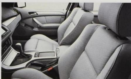
□ **Sportsitz** für Fahrer und Beifahrer (hier abgebildet in Leder), inkl. Rafftaschen, Sitzverstellung für Fahrer- und Beifahrersitz elektrisch, mit Memory-Funktion für Fahrersitz; optimaler Seitenhalt in jeder Fahrsituation durch hoch ausgeformte Sitzwangen; Sitzhöhe, Lehnen- und Sitzneigung sowie Oberschenkelauflage sind individuell verstellbar. (Serie 4.6is.)
