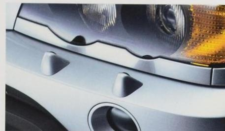
□ **Scheinwerfer-Reinigungsanlage:** Parallel zur Frontscheibe werden bei eingeschaltetem Licht über den Lenkstockhebel rechts auch die Scheinwerfergläser automatisch gereinigt. (Serie 4.6is.)
