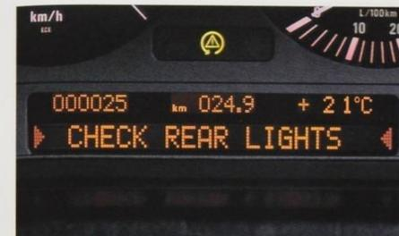
□ **Check-Control** (mit Piktogrammanzeige Serie 3.0i und 3.0d, mit alphanumerischer Anzeige Serie 4.4i und 4.6is) überwacht z. B. den Bremsflüssigkeitsstand sowie alle wichtigen Einrichtungen und Leuchten (hier abgebildet 4.4i).
