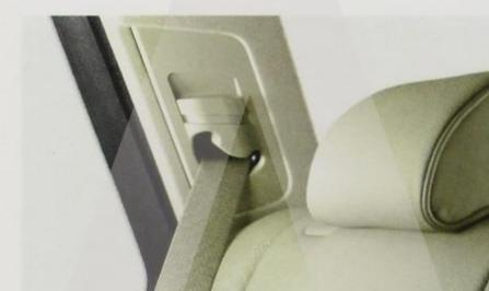
■ **Gurtpunkthöhenverstellung**, manuell, an der B-Säule und der C-Säule.
