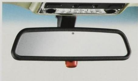
■ **Innenspiegel automatisch abdimmend**: Ab einem definierten Lichteinfall durch nachfolgende Fahrzeuge blendet der Spiegel automatisch ab.
