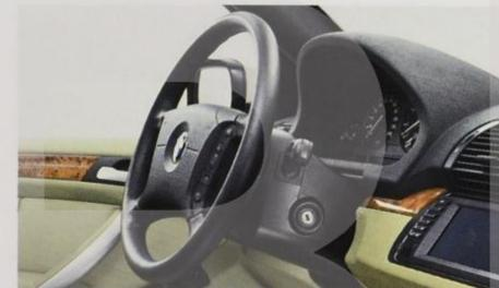
□ **Servotronic**: Elektronisch-hydraulische Lenkhilfe zur Unterstützung beim Parken und Rangieren, arbeitet in Abhängigkeit von der gerade gefahrenen Geschwindigkeit; durch die Crash-optimierte Sicherheitslenksäule wird das Lenkrad bei einer Frontalkollision vom Fahrer weg bewegt. (Serie 4.6is.)
