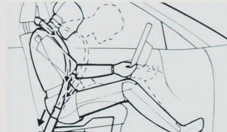
■ **BMW Rückhaltesystem** für Fahrer und Beifahrer, Kombination aus Dreipunkt-Sicherheitsgurt (mit manueller Gurtpunkthöhenverstellung an der B-Säule), Gurtstrammer, Gurtkraftbegrenzer und Submarining-Stütze im Sitz, sorgt für bestmögliche Rückhaltewirkung bei einer Kollision.
