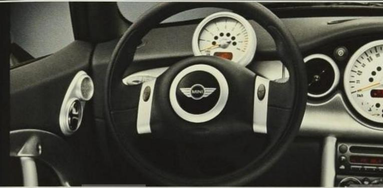
Im zweispeichigen **Serienlenkrad** ist der Fahrer-Airbag (zweistufig) integriert, links und rechts ist jeweils eine Hupentaste platziert.
