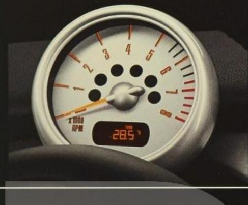
Der **Drehzahlmesser** ist gut ablesbar mitig auf der Lenksäule angeordnet. Eine Warnleuchte informiert, wenn ASC+T bzw. DSC regelnd eingreift. Zusätzlich werden die Außentemperatur und die Momentangeschwindigkeit angezeigt.
