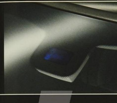
Einmal aktiviert, schaltet der **Regensensor** – je nach Stärke des Regens – die Scheibenwischer ein und regelt automatisch die Wischfrequenz. Der integrierte **Lichtsensor** aktiviert bei Bedarf die Fahrlichtautomatik bei Dämmerung und Dunkelheit.
