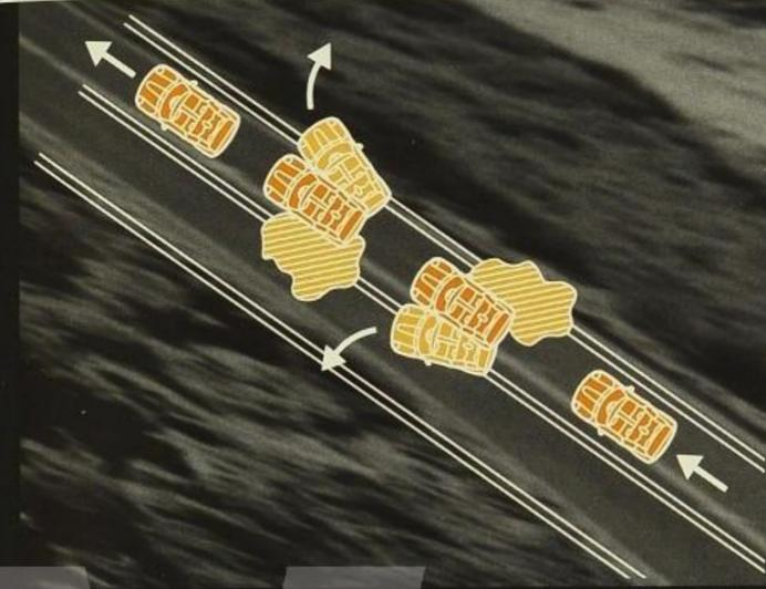
**DIE AUTOMATISCHE STABILITÄTS CONTROL UND TRAKTION:** (serienmäßig für MINI Cooper S Cabrio) verhindert ein Durchdrehen der angetriebenen Vorderräder, für optimales Anfahrverhalten und sichere Traktion.
