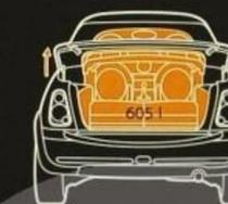
Mit geöffnetem Verdeck fasst der Gepäckraum 120 Liter, geschlossen 165 Liter. Öffnen Sie die nach unten aufschwenkende Heckklappe, entsteht bei geschlossenem Verdeckteil eine große Öffnung (Easy-Load) zum bequemen Ein- und Ausladen. Zusammen mit den einzeln oder komplett umlegbaren Rücksitzlehnen lässt sich der Gepäckraum so auf bis zu 605 Liter vergrößern.
