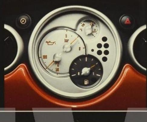
Für alle Modelle ist optional ein **Cockpit Chrono Paket** inkl. Bordcomputer erhältlich. Es umfasst Anzeigen für Tankinhalt, Öl- und Kühlwassertemperatur sowie Öldruck. In Verbindung mit diesem Paket sind Tacho und Drehzahlmesser auf der Lenksäule platziert.
