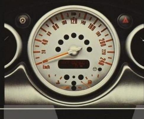
Im zentral angeordneten **Tachometer** befindet sich **eine Digitaluhr** und ein LC-Display für Kilometer- und Tageskilometerzähler. Außerdem Kontrollleuchten u. a. für Kraftstoffreserve, Blinker, Ölstand, Fernlicht, RPA, ABS, Bremsbelagverschleiß-Anzeige und eine Airbag-Warnleuchte.
