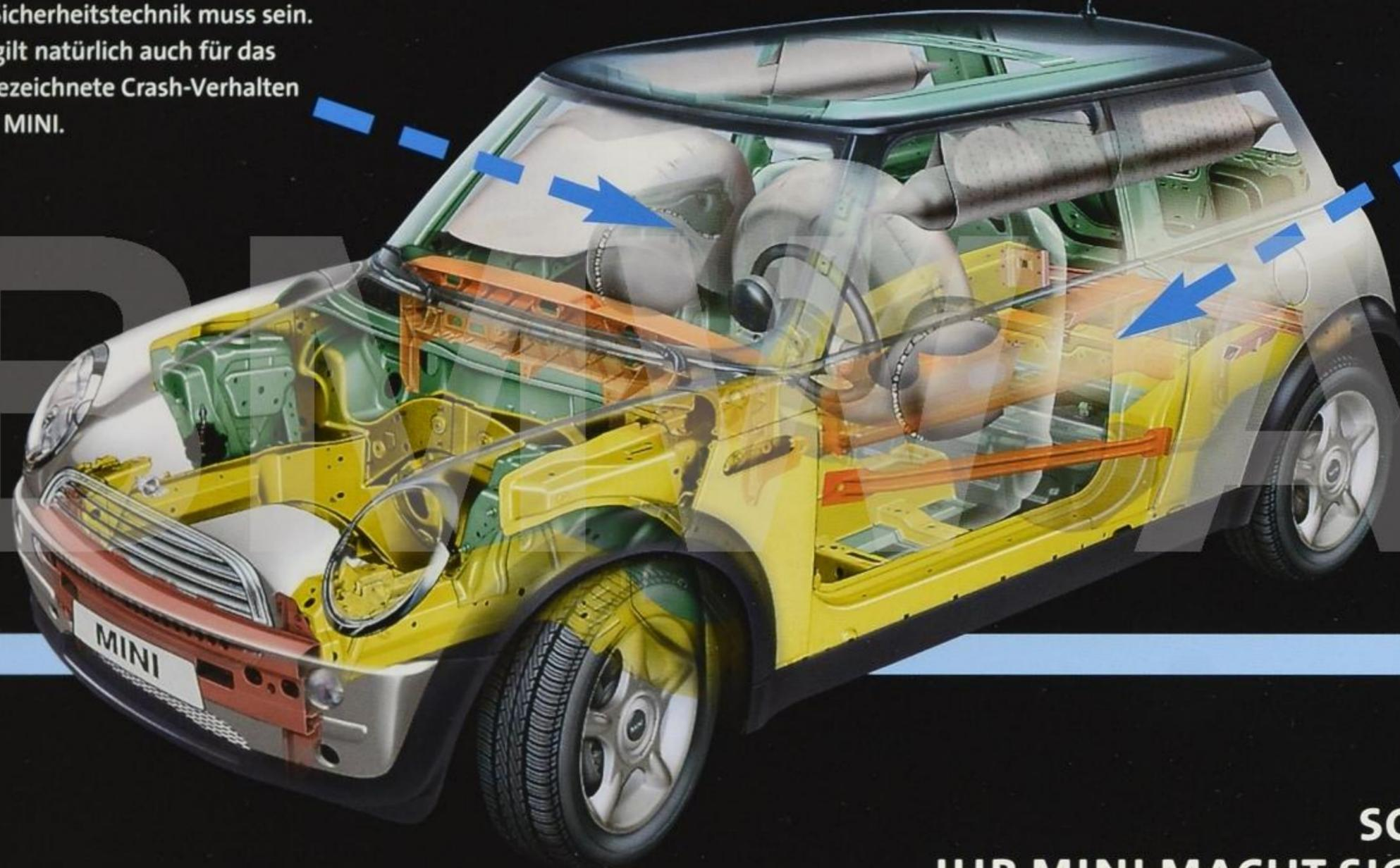
Die Torsions- und Biegesteifigkeit der verstärkten Fahrgastzelle Ihres MINI ist nicht einfach so hoch wie die der Wettbewerber, sondern zwei- bis dreimal höher.
