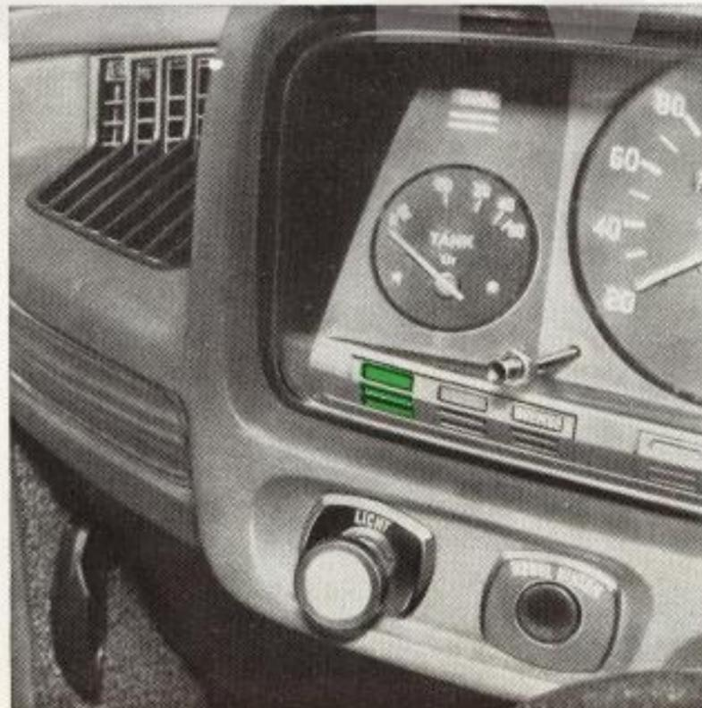
Die **Parkleuchten** der jeweiligen Fahrzeugseite werden mit dem Blinkerhebel bei abgesperrtem Lenkschloß eingeschaltet.
