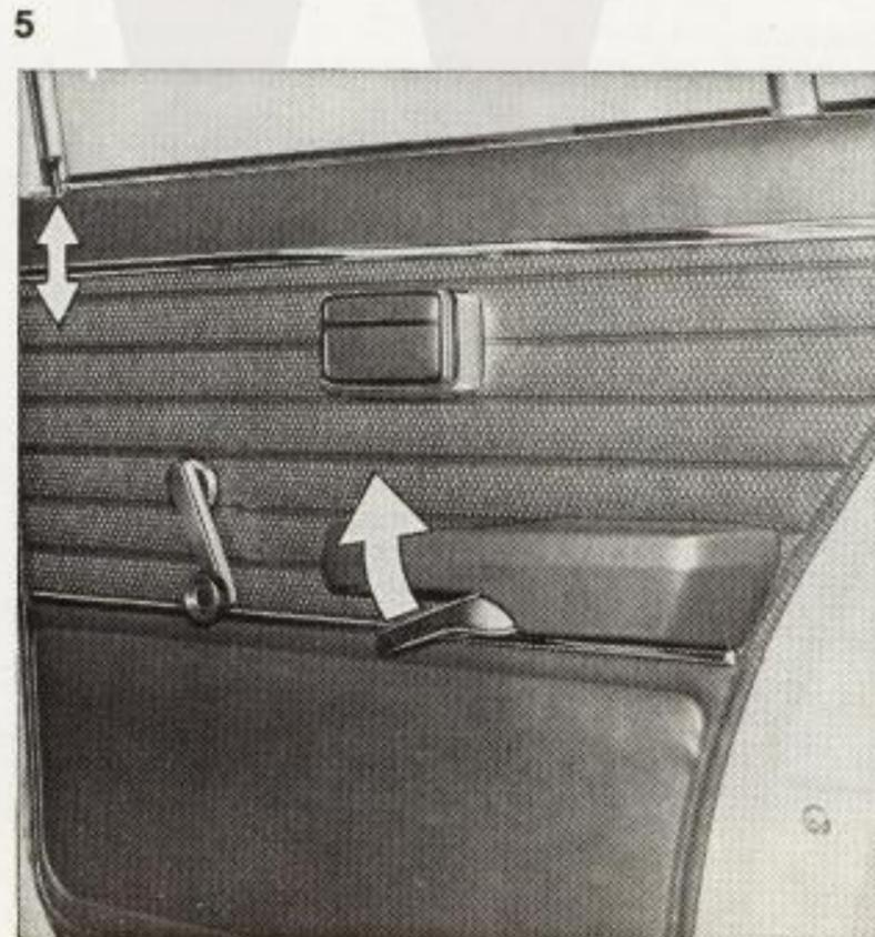
Jede der beiden Hintertüren ist mit einer **Kindersicherung** versehen, die bei geöffneter Tür eingelegt werden kann. **Bild 6**
