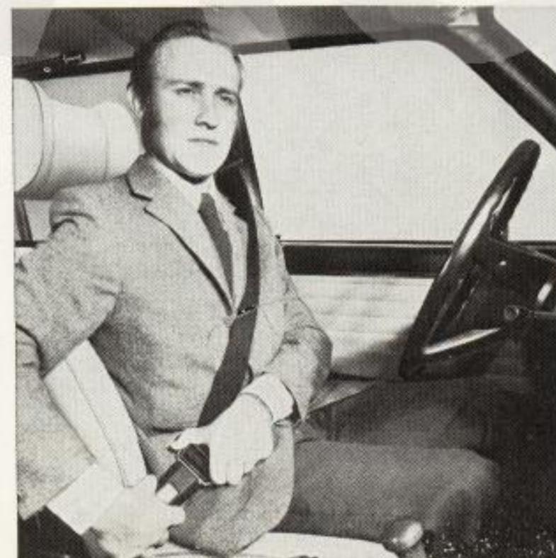
Zum Öffnen des geschlossenen Gurtes ist auf die Betätigungstaste im Schloßteil zu drücken. **Bild 34**
