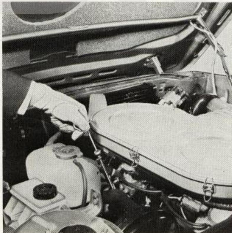
Einfüllstutzen auf keinen Fall bei laufendem Motor öffnen! **Übergang auf eine andere Ölsorte bitte nur anlässlich eines Ölwechsels mit Ölfilterwechsel.** Unsere Motoren sind konstruktiv so ausgelegt, daß in Verbindung mit den heutigen hochentwickelten Markenschmierölen **keine Ölzusätze** erforderlich sind. Das gleiche gilt für Schalt-, Automatic-, Hinterachsgetriebe und Hydrolenkung.
