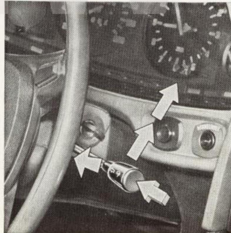
Ziehen des Wisch-Wasch-Hebels zum Lenkrad hin, betätigt die Scheibenwasch-Automatik. Es werden dabei gleichzeitig die elektrische Pumpe und die Scheibenwischer eingeschaltet. Nach Loslassen des Hebels sorgt ein Verzögerungsrelais für die Wischerabschaltung nach beendeter Scheibenreinigung.
