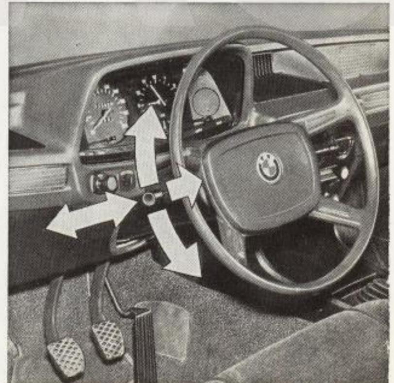
Durch Betätigung des **Blinkhebels** nach oben oder unten sind die rechten bzw. linken Blinkleuchten eingeschaltet.
