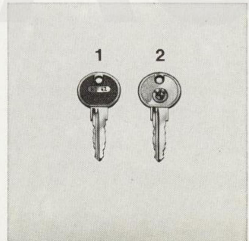
Der Zentralschlüssel 1, **Bild 3**, paßt für alle Schlösser an Ihrem BMW. Mit dem Schlüssel 2, **Bild 3**, passend nur für die beiden Vordertüren und den Zündanlaßschalter, schließen Sie die Türen auf durch Drehen in Fahrtrichtung und schließen sie ab durch Drehen entgegen der Fahrtrichtung. Durch diese Schlüssel- bzw. Schloßkombination kann das Gepäck in der Garage oder Werkstätte unter Verschuß bleiben.
