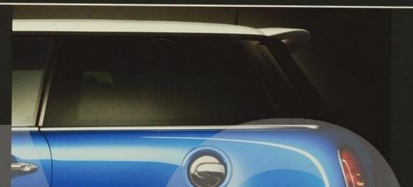
Die **Sonnenschutzverglasung** reduziert bei starker Sonneneinstrahlung die Aufheizung des Innenraums und trägt zu einem angenehmeren Klima bei. Die Seitenscheiben ab der B-Säule und die Heckscheibe bestehen bei dieser Ausstattung aus deutlich sichtbar abgedunkeltem Glas.
