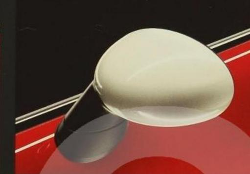
Die elliptischen **Außenspiegelkappen** sind für den MINI One immer in **Schwarz matt** ausgeführt. Sie sind elektrisch verstellbar, asphärisch und auf Wunsch beheizt. Durch das asphärische Glas wird der sogenannte „Tote Winkel“ verkleinert.
