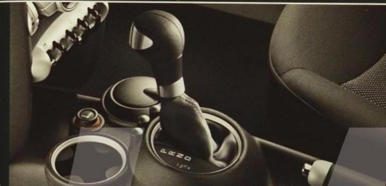
Die optionale **6-Gang-Automatik** mit Steptronic ermöglicht sehr komfortable und im Steptronic-Modus auch sehr sportliche Gangwechsel.
