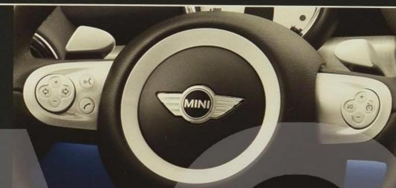
Die 6-Gang-Automatik verfügt zusätzlich zum Wählhebel über zwei **Schaltwippen im Lenkrad**. Für sehr schnelle und sehr sichere Gangwechsel – die Hände bleiben stets am Lenkrad.
