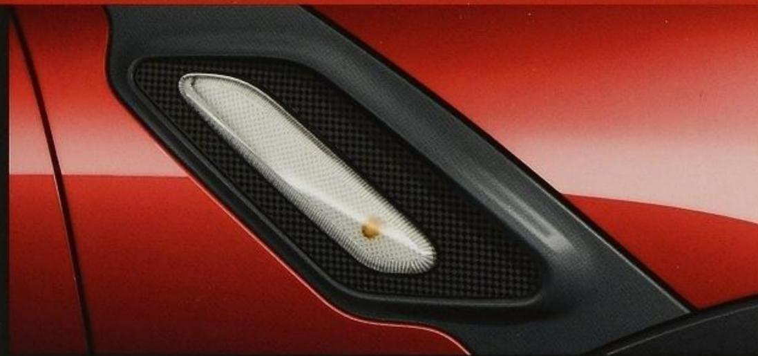
Die Blinkleuchten sind in die Side Scuttles in Black Checkered integriert.
