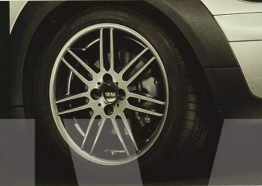
Erhältlich in Graumetallic und in Silber – das **Leichtmetallrad Double Spoke R99**. Die Größe beträgt 7 J x 17 Zoll, die Runflat-Bereifung hat das Format 205/45 R 17.
