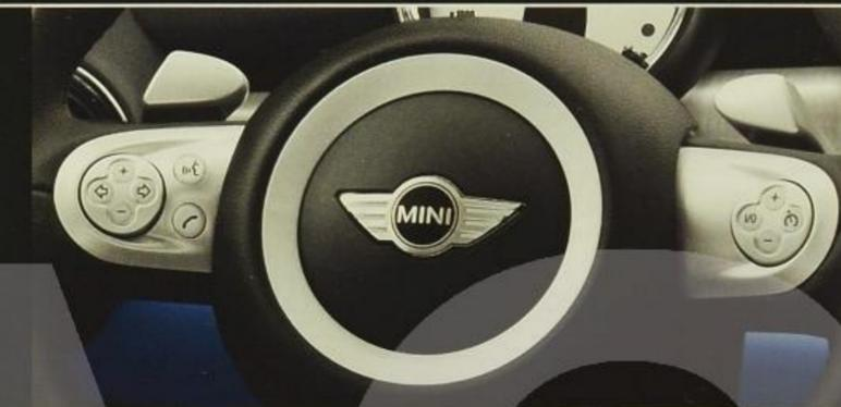
Die 6-Gang-Automatik verfügt zusätzlich zum Wählhebel über zwei **Schaltwippen im Lenkrad**. Für sehr schnelle und sehr sichere Gangwechsel, die Hände bleiben stets am Lenkrad.
