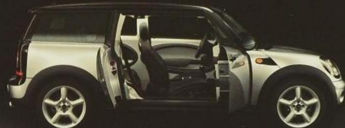
Welcome to the Club. Die hintere Tür öffnet entgegen der Fahrtrichtung und ermöglicht einen komfortablen Zugang zur Rückbank.
