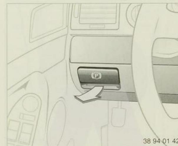
Zum Lösen der Bremse den Griff ziehen. Bitte beachten Sie, daß die Bremse dann unmittelbar löst.
