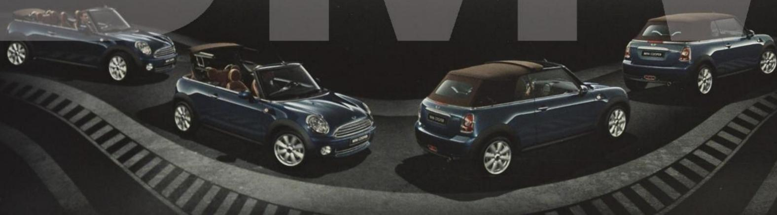
Das Verdeck im MINI Cabrio lässt sich auf Knopfdruck nicht nur vollständig öffnen oder schließen (in nur 15 Sekunden), sondern auch als Schiebedach nutzen – bis 40 Zentimeter weit, und auch während der Fahrt bis 120 km/h.
