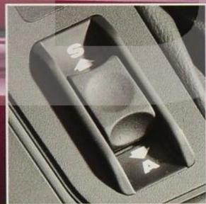
Die 4-Gang-Automatic im BMW 850Ci hat jetzt eine Adaptive Getriebesteuerung (AGS). Dieses System erkennt die Fahrweise des Fahrers, berücksichtigt zudem Straßenbedingungen und Fahrsituationen und regelt die Steuerung des Getriebes dementsprechend.
