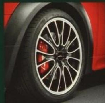
**Leichtmetallrad Cross-Spoke R113, glanzgedreht**, 7 J x 18 Zoll, Runflat-Bereifung 205/40 R18, Satz/4 St.
