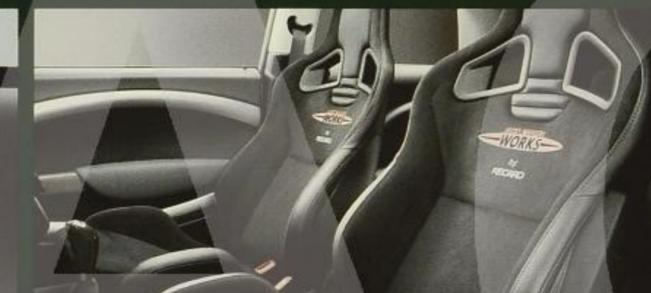
Authentisches Motorsportdesign: Die John Cooper Works Sportsitze gibt es in Alcantara oder Leder. Ihr Sitzrahmen ist aus leichten Kunststoffschalen gefertigt und verfügt über ausgeprägte Seitenwangen, die extremen Halt bieten. Mit Seitenairbag, Fondeneinstiegs-hilfe und 2-stufiger Höhenverstellung.
