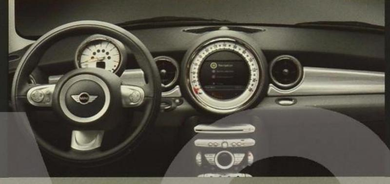
Serienmäßig ist die **Interieuroberfläche** im **MINI One**, **MINI Cooper** und **MINI Cooper D** in **Fine White Silver** ausgeführt. Weitere Umfänge dieser Ausstattung: Einfassungen von Drehzahlmesser, Tachometer, Luftdüsen und Schalthebel in Silber.
