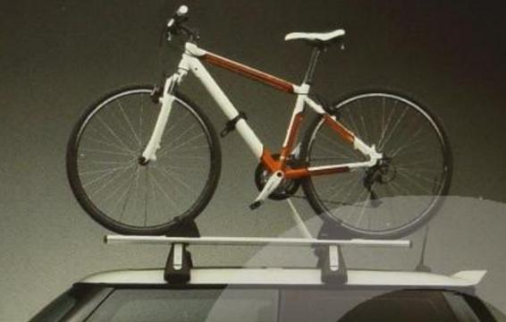
Der einfach anzubringende **Grundträger** aus hochfestem Aluminium-Profilrohr ist besonders stabil und korrosionsbeständig. Die nutzbare Breite beträgt etwa 900 mm. Er ist die Basis für verschiedene Aufsätze, mit denen sich beispielsweise Fahrräder oder eine Dachbox transportieren lassen. Die max. Dachlast beträgt 75 kg.
