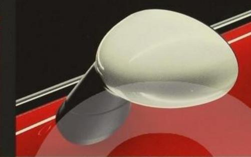
Die elliptischen **Außenspiegelkappen** sind für den MINI One immer in **Schwarz matt** ausgeführt. Sie sind elektrisch verstellbar und auf Wunsch beheizt. Durch das asphärische Glas auf der Fahrerseite wird der sogenannte „Tote Winkel“ verkleinert.
