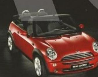
Das Verdeck im MINI Cabrio lässt sich auf Knopfdruck nicht nur vollständig öffnen oder schließen (in nur 15 Sekunden), sondern auch als Schiebedach nutzen – bis 40 Zentimeter weit, und auch während der Fahrt bis 120 km/h.
