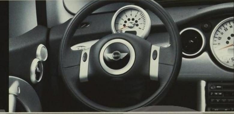
Im zweispeichigen **Lederlenkrad** (optional MINI One, MINI One D und MINI Cooper) ist der zweistufige Airbag integriert, links und rechts ist jeweils eine schwarze Taste für die Hupe angeordnet.
