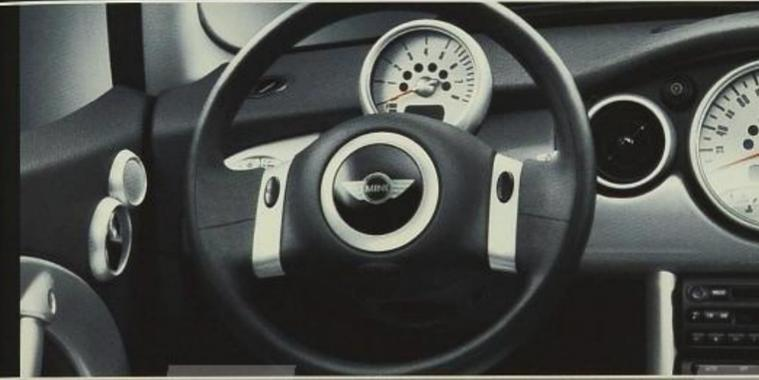
Im zweispeichigen **Serienlenkrad** ist der zweistufige Airbag integriert, links und rechts ist jeweils eine Hupentaste platziert.
