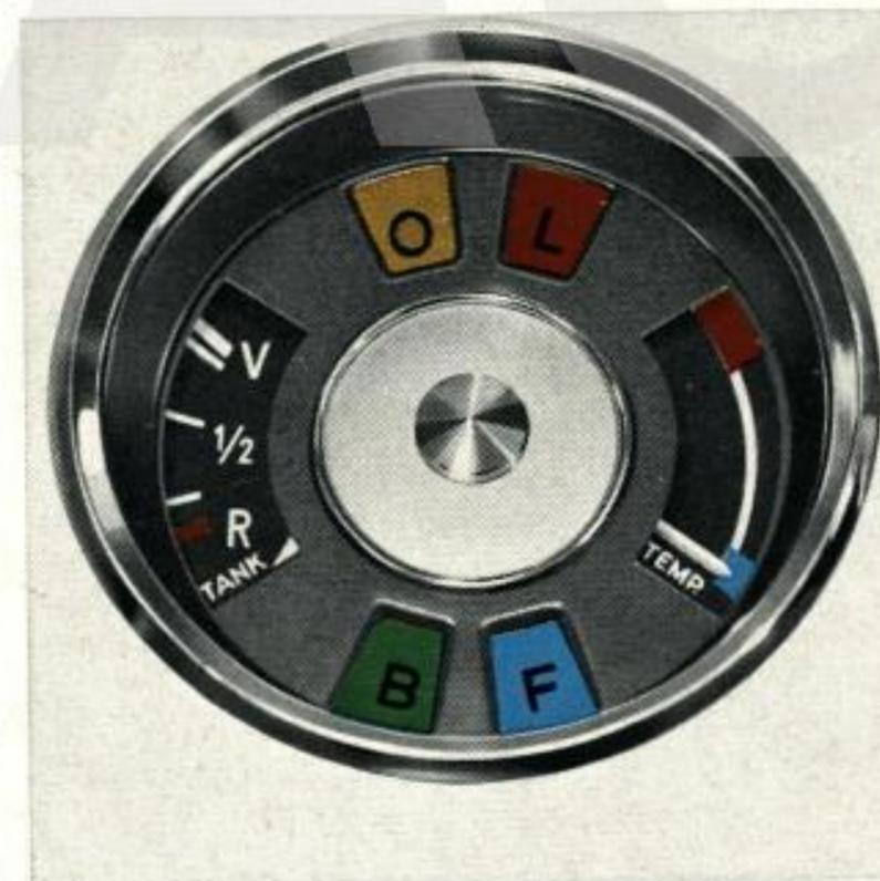
Am **Kraftstoffanzeiger** im Kombi-Instrument kann bei eingeschalteter Zündung der Kraftstoffstand abgelesen werden. Steht der Zeiger auf „**Reserve**“, dann sollten Sie tanken, obwohl noch für etwa 50 km (je nach Fahrweise) Kraftstoff im Behälter ist. **Bild 30**
