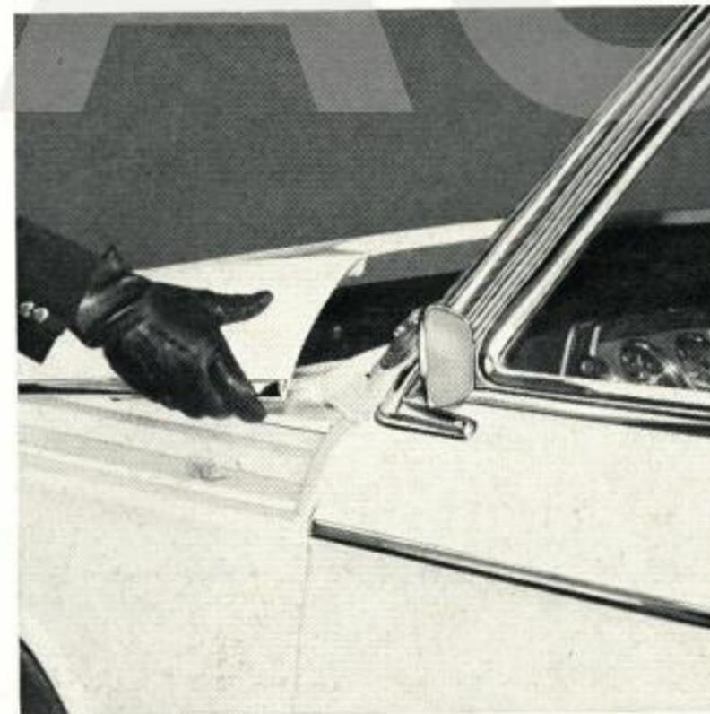
**Achtung!** Zuklappen der Motorhaube nur bei nach vorn stehendem Hebel. Nach dem Schließen muß die Haube wieder durch Ziehen des Hebels verriegelt werden. **Bild 14**
