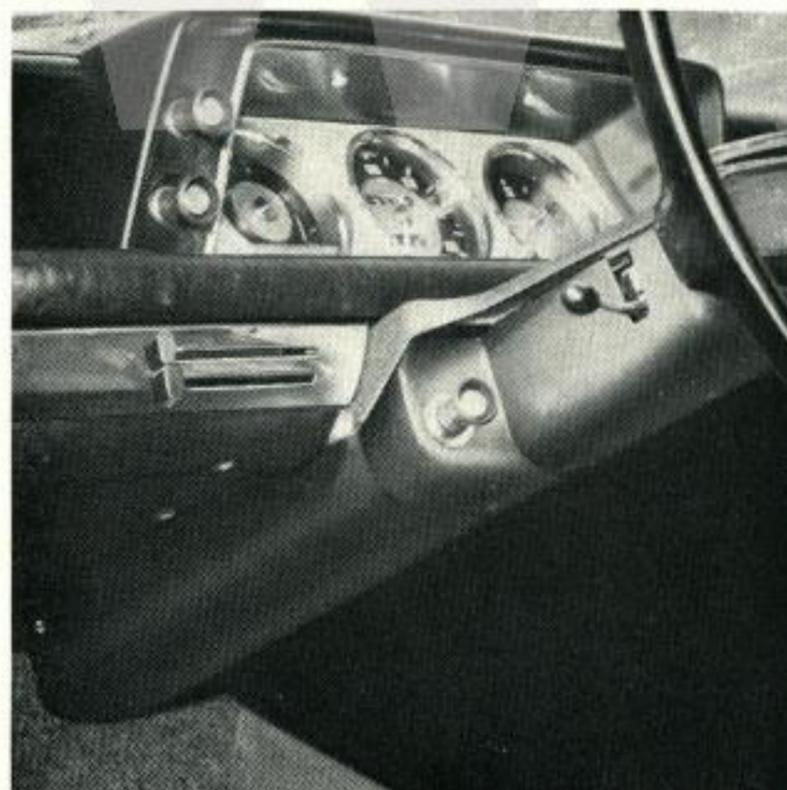
start-Zugknopf so weit hineinschieben, bis der Motor rundläuft.
