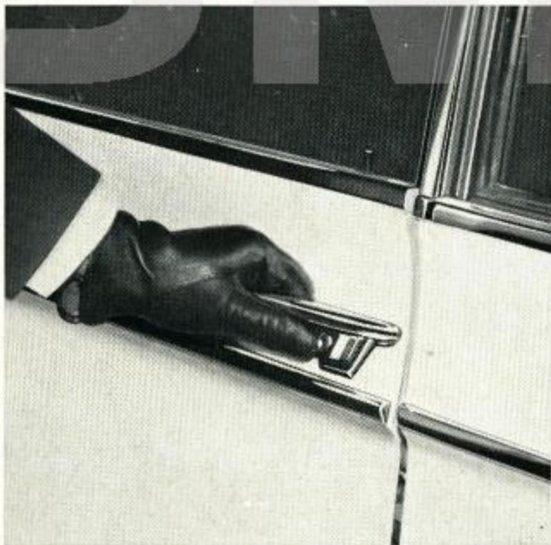
Absperren der Türen von innen durch Niederdrücken der Sicherungsknöpfe; zum Öffnen von innen erst Sicherungsknopf und dann den Türriegel unter der Armlehne hochziehen. **Bild 3**
