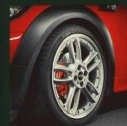
Packend: das Leichtmetallrad Double Spoke Composite R109. In 18 Zoll und mit Runflat-Bereifung 205/40 R18.
