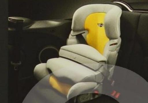
**ISOFIX** (Abb. mit Kindersitz aus dem Zubehörprogramm) ist ein genormtes System, bei dem ein mit zwei Teleskopstangen ausgerüsteter Baby- oder Kindersitz im hinteren Bereich der Rücksitzbank sicher und fest eingerastet wird.
