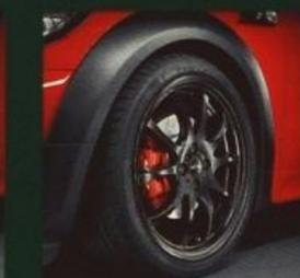
Glanzgedreht oder in Schwarz matt: das Leichtmetallrad Double Spoke R105 in 18 Zoll, Runflat-Bereifung 205/40 R18.
