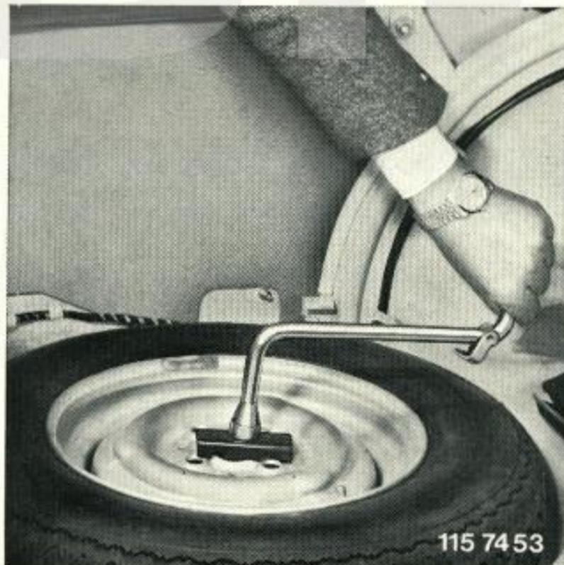
Radkappe mit dem hierfür vorgesehenen Haken des Radmutter-schlüssels vorsichtig abdrücken und mit der Hand auf-fangen (**Bild 47**). Radmuttern lockern. Wagenheber ansetzen (bitte nur an einem der hierfür vorgesehenen vier Aufnahmepunkte) und so weit hochkur-beln, bis sich das betreffende Rad weit genug vom Boden abhebt. **Bild 48**
