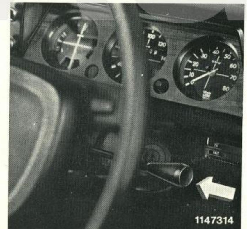
Ziehen des Wisch-Wasch-Hebels zum Lenkrad hin, betätigt die Scheibenwasch-Automatik. Es werden dabei gleichzeitig die elektrische Pumpe und die Scheibenwischer eingeschaltet. Nach Loslassen des Hebels sorgt ein Verzögerungsrelais für die Wischerabschaltung nach beendeter Scheibenreinigung. **Bild 12**
